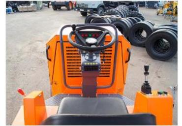
Работа с грунтами (песчаными либо щебнистыми), а также с АБС при благоустройстве дорожных покрытий на городских дорогах общего типа и автотрассах требует применения вибрационных дорожных катков. Одной из подходящих моделей для ремонта, строительства, реконструкции дорог является самоходный каток DM-03-VC для промышленных масштабов работ.
